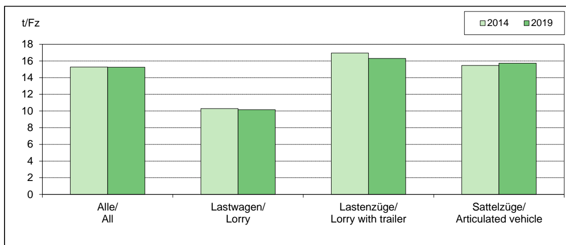
Alpenquerender Güterverkehr (AQGV) 2014-2019 / Cross-Alpine Freight Traffic (CAFT) 2014-2019 Schweiz: Durchschnittliches Leergewicht der Strassengüterfahrzeuge nach Fahrzeugtypen / Switzerland: Average empty weight of road goods vehicles by type of vehicle
