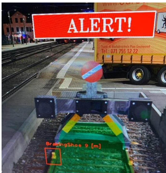
Abbildung 10: Vom Objekterkennungssystem erkannter Hemmschuh und Gleisabschluss.
