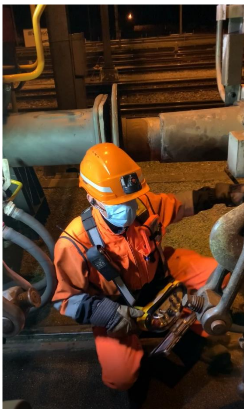
Abbildung 9: Kuppelversuch mit Funkfernbedienung und Tablet für die Bildübertragung.
