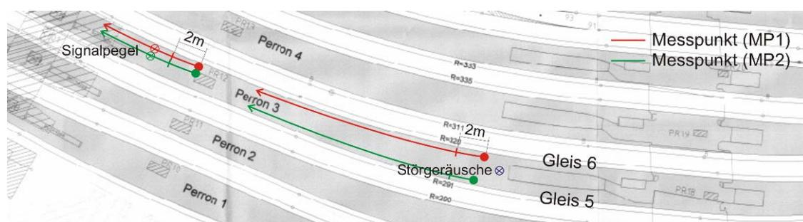
Abbildung 7.12: Messpunkte bei der Messung des Störpegels (2.1), des Signalpegels (3.1) und bei der Messung des STI (4.1) an Gleis 6 außerhalb der Bahnhofshalle
