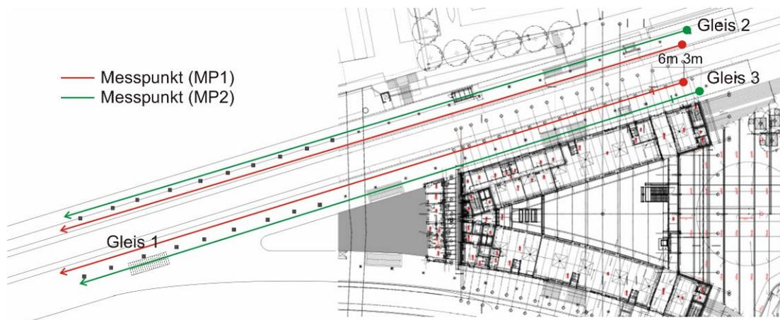
Abbildung 5.4: Messpunkte bei der STI-Messung auf den Gleisen 1 / 3 (Messung 4.1) und Gleis 2 (Messung 4.2) im Raster 6 m x 3 m.
