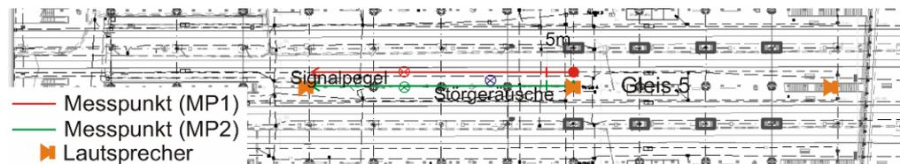
Abbildung 8.3: Messpunkte bei der Messung des Störpegels (Messung 2.1), bei der Messung des Signalpegels (Messung 3.1) sowie bei der Messung des STI 1 (4.1) auf Gleis 5
