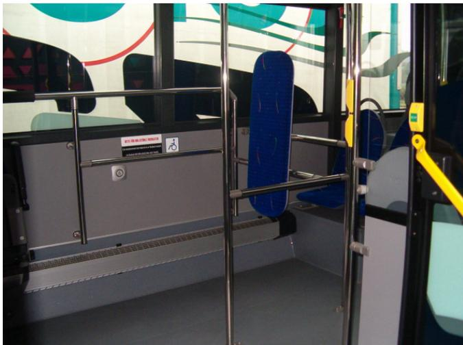
Einziges Beispiel mit Haltestange zur Sicherung gegen Abdrehen (nach EU-Richtlinie). Andere Vor- und Nachteile wie oben, vor allem fehlende Abstützung des Rollstuhles in Fahrtrichtung und schwieriges Manövrieren wegen relativ langer Stange.
