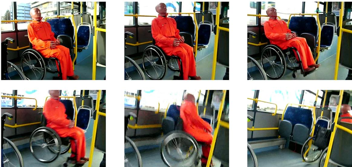
*Bild 7: oben: Ausgangsposition, leichtes Rutschen nach vorn (aus Sicht des Rollstuhlfahrers), Kippen nach hinten mit Kopfanprall. Unten: nach Zurückkippen Rutschen nach vorn. Gewichtsverlagerung auf linkes Rad, rechtes Rad hebt ab, Rotation um Auflagepunkt des linken Rades, Sturz in Sitzbänke.*
