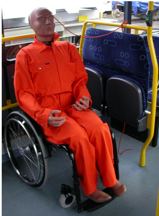
*Bild 5: Versuchsaufbau (vor Versuch 4). Die Querstange oberhalb der Klappsitz-Lehne ist ungepolstert. Unterhalb der Klappsitze ist keine Haltevorrichtung montiert.*
