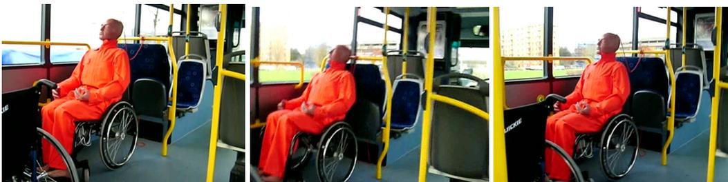
*Bild 6: Anfangs- und Endposition, dazwischen Kopfanprall bei Versuch 2*
