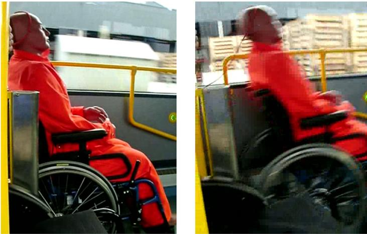
*Bild 9: links Ausgangsposition, rechts Rollstuhl in Bewegung nach Vollbremsung. Die Räder drehen sich. Der Dummy behält seine Position auf dem Rollstuhl bei.*
