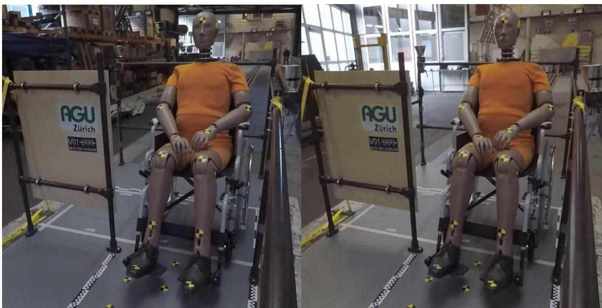
Bild 5: Versuch V01,  $v=15 \text{ km/h}$ ,  $a=1 \text{ m/s}^2$ , Gefälle=0 ‰. Der Rollstuhl bleibt stabil.
