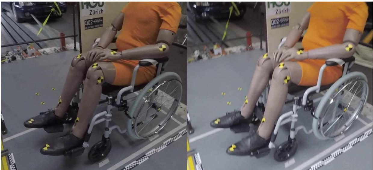
*Bild 17: Versuch Q02,  $v=15$  km/h,  $a=2$  m/s<sup>2</sup>, Gefälle=0 ‰. Der Rollstuhl bleibt stabil. Die Vorderräder sind in Fahrrichtung nach vorn gestellt (stabiler als Q03)*
