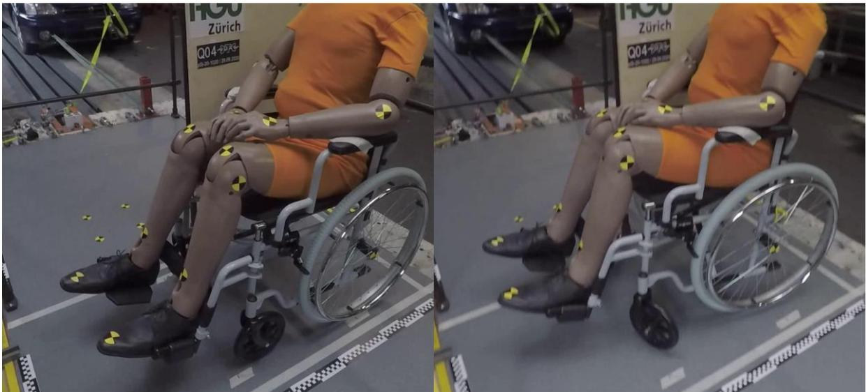
*Bild 19: Versuch Q04,  $v=15$  km/h,  $a=2$  m/s<sup>2</sup>, Gefälle=0 ‰. Der Reibungskoeffizient ist nur 0.3, gegenüber 0.45 in allen anderen Versuchen. Der Rollstuhl rutscht seitlich und dreht sich leicht. Anprall ans RHS. Die Vorderräder sind in Fahrrichtung nach hinten gestellt.*
