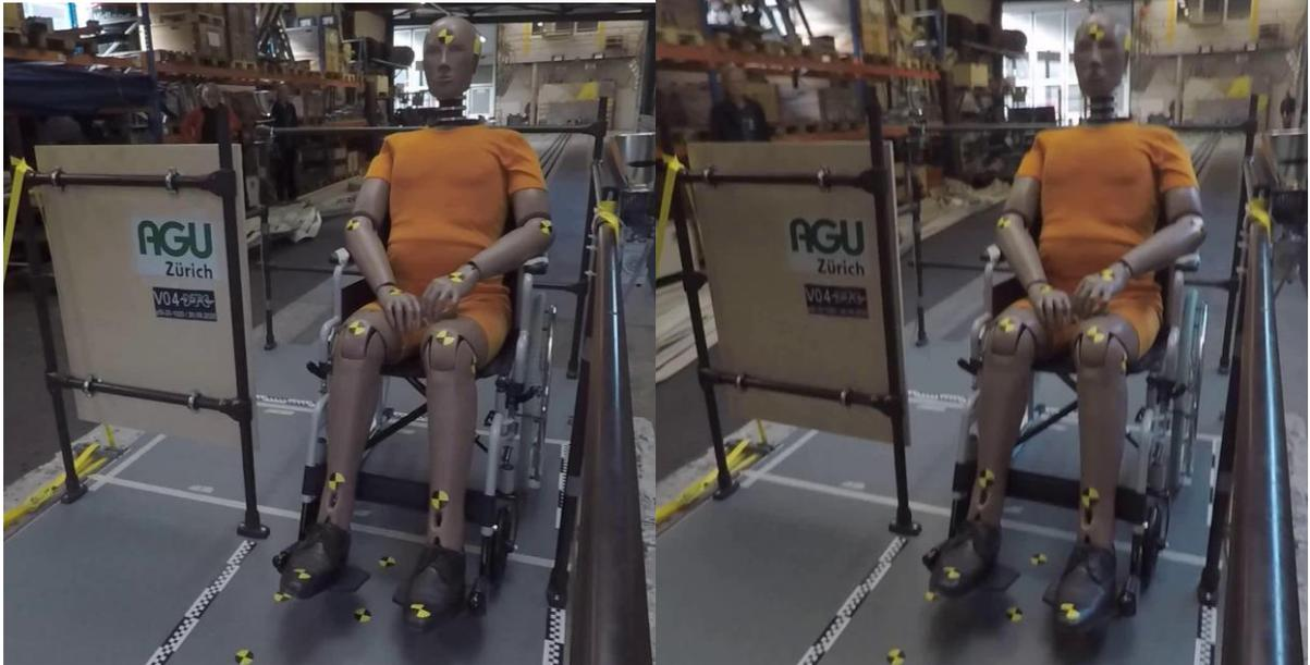
Bild 8: Versuch V04,  $v=15 \text{ km/h}$ ,  $a=1.5 \text{ m/s}^2$ , Gefälle=0 ‰. Der Rollstuhl bleibt knapp stabil. Die Vorderräder sind in Fahrrichtung nach vorn gestellt (stabiler als V03).
