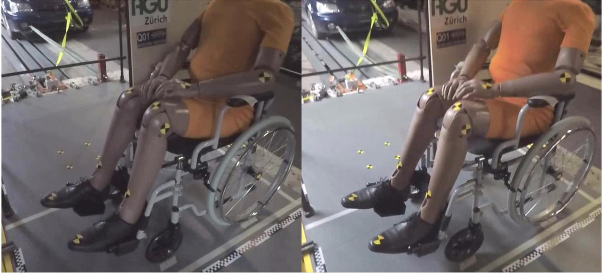
*Bild 16: Versuch Q01,  $v=15$  km/h,  $a=1$  m/s<sup>2</sup>, Gefälle=0 ‰. Der Rollstuhl bleibt stabil. Die Vorderräder sind in Fahrrichtung nach vorn gestellt (stabiler als Q03)*
