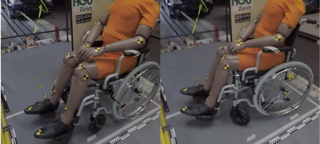
*Bild 20: Versuch Q05,  $v=15$  km/h,  $a=2.5$  m/s<sup>2</sup>, Gefälle=0 ‰. Der Rollstuhl rutscht etwas seitlich und dreht sich. Anprall ans RHS. Die Vorderräder sind in Fahrrichtung nach hinten gestellt.*
