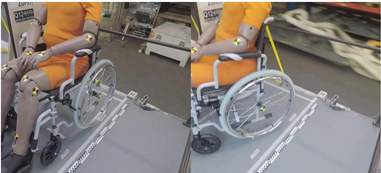
*Bild 27: Versuch Q12,  $v=15$  km/h,  $a=2.5$  m/s<sup>2</sup>, Gefälle=50 ‰, Position 10 cm weiter vorn. Der Rollstuhl rutscht etwas seitlich und dreht sich. Anprall ans RHS. Die Vorderräder sind in Fahrrichtung nach vorn gestellt.*
