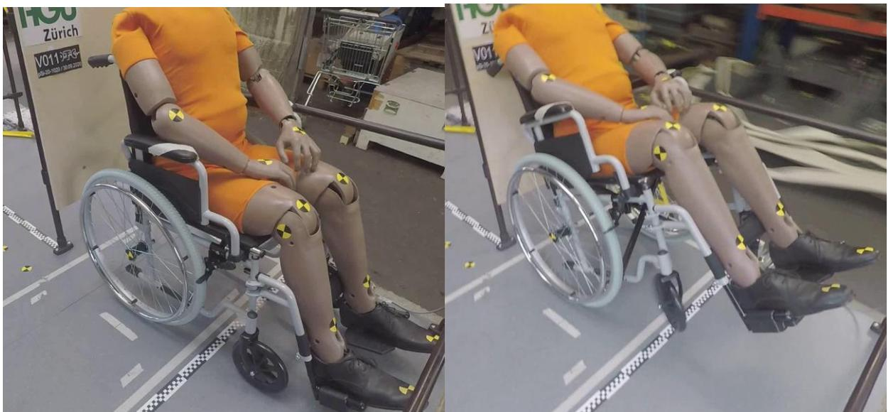
Bild 15: Versuch V11,  $v=15$  km/h,  $a=2.5$  m/s<sup>2</sup>, Gefälle=50 %. Der Rollstuhl kippt vollständig.
