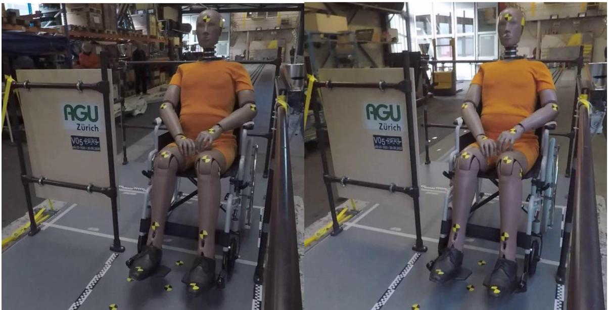
Bild 9: Versuch V05,  $v=15 \text{ km/h}$ ,  $a=1.8 \text{ m/s}^2$ , Gefälle=0 ‰. Der Rollstuhl bleibt rutscht einige cm. Die Vorderräder sind in Fahrrichtung nach vorn gestellt (stabiler als V03).
