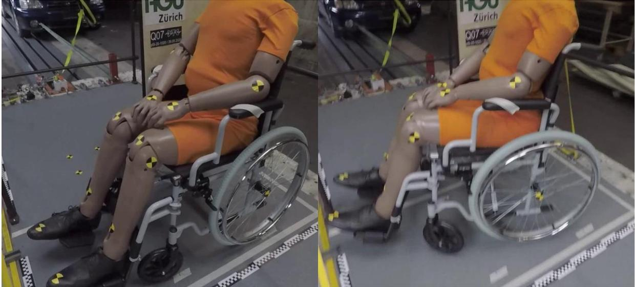
*Bild 22: Versuch Q07,  $v=15 \text{ km/h}$ ,  $a=2.5 \text{ m/s}^2$ , Gefälle=0 ‰. Position 10 cm weiter vorn. Der Rollstuhl rutscht etwas seitlich und dreht sich. Anprall ans RHS. Die Vorderräder sind in Fahrrichtung nach vorn gestellt.*
