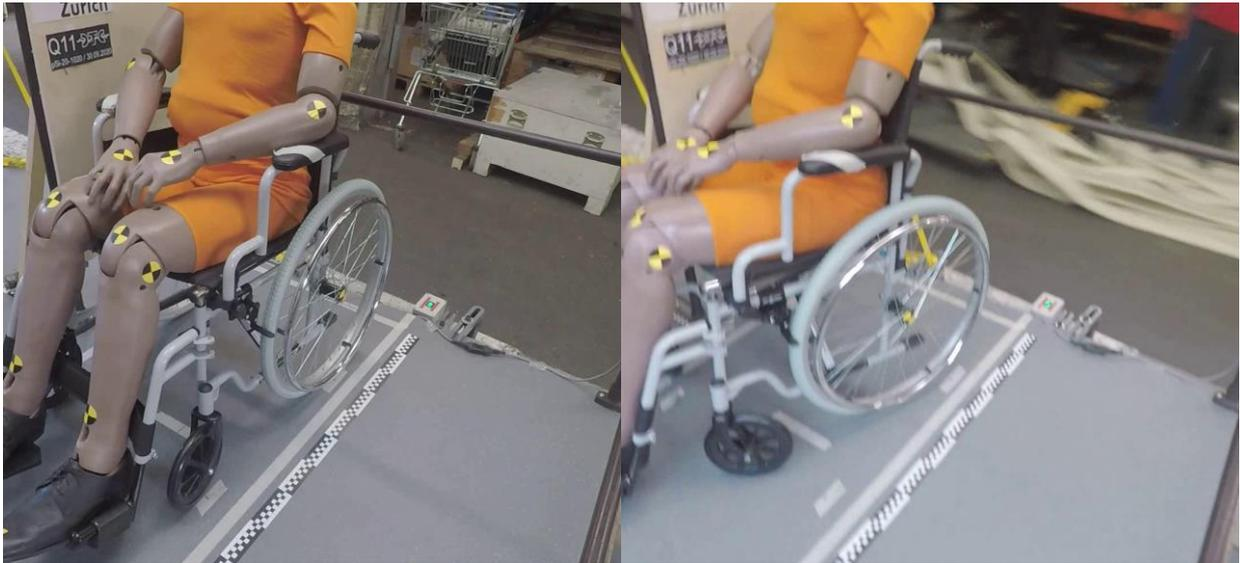
*Bild 26: Versuch Q11,  $v=15$  km/h,  $a=2$  m/s<sup>2</sup>, Gefälle=50 ‰. Der Rollstuhl rutscht etwas seitlich und dreht sich. Anprall ans RHS. Die Vorderräder sind in Fahrrichtung nach vorn gestellt.*
