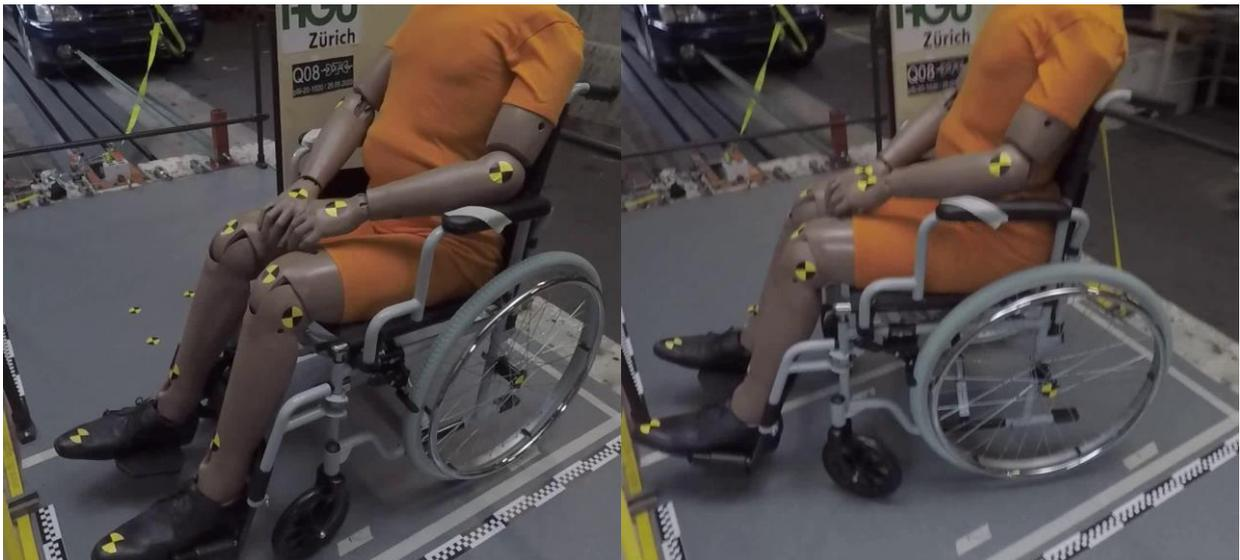
*Bild 23: Versuch Q08,  $v=25 \text{ km/h}$ ,  $a=2.5 \text{ m/s}^2$ , Gefälle=0 ‰. Position 10 cm weiter vorn und höhere Geschwindigkeit. Der Rollstuhl rutscht etwas seitlich und dreht sich. Anprall ans RHS. Die Vorderräder sind in Fahrrichtung nach vorn gestellt.*
