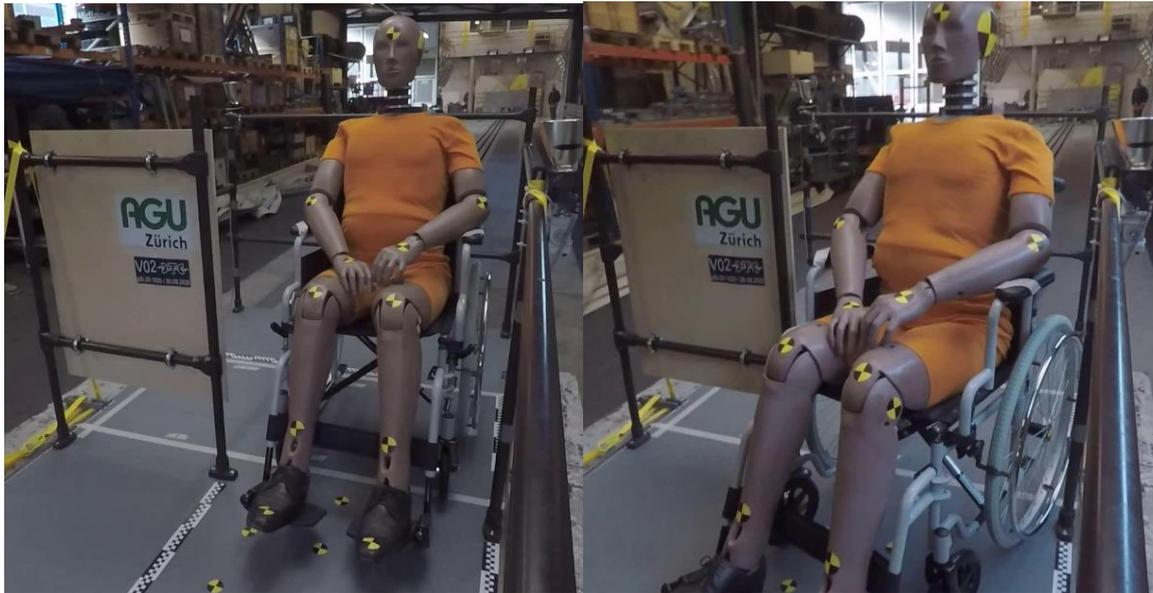
*Bild 6: Versuch V02,  $v=15$  km/h,  $a=2$  m/s<sup>2</sup>, Gefälle=0 ‰. Der Rollstuhl rutscht deutlich nach vorne und dreht sich leicht.*
