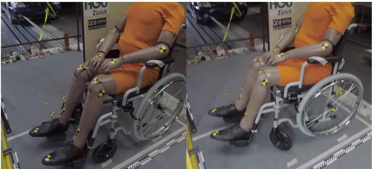
*Bild 21: Versuch Q06,  $v=15$  km/h,  $a=2.5$  m/s<sup>2</sup>, Gefälle=0 ‰. Der Rollstuhl rutscht etwas seitlich und dreht sich. Anprall ans RHS. Die Vorderräder sind in Fahrrichtung nach vorn gestellt.*
