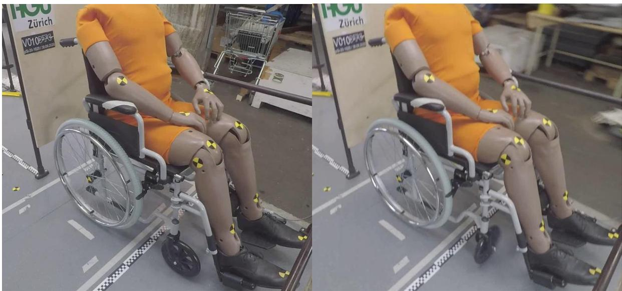
Bild 14: Versuch V10,  $v=15$  km/h,  $a=2.0$  m/s<sup>2</sup>, Gefälle=50 %. Die Vorderräder werden leicht abgehoben.
