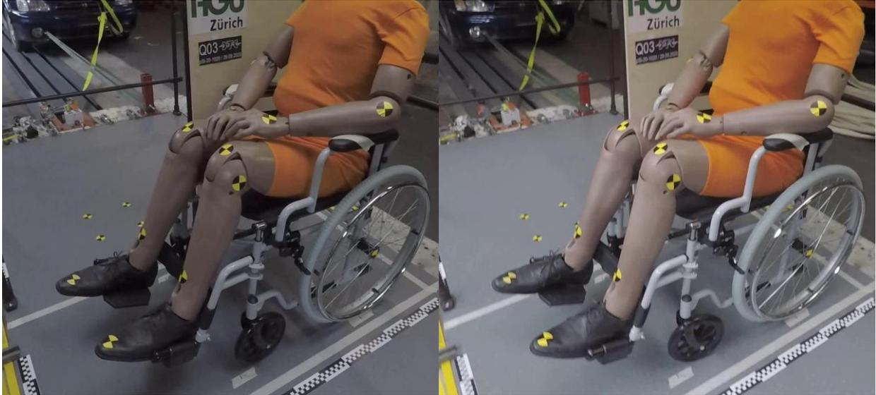
*Bild 18: Versuch Q03,  $v=15$  km/h,  $a=2$  m/s<sup>2</sup>, Gefälle=0 ‰. Der Rollstuhl bleibt knapp stabil. Die Vorderräder sind in Fahrrichtung nach hinten gestellt.*
