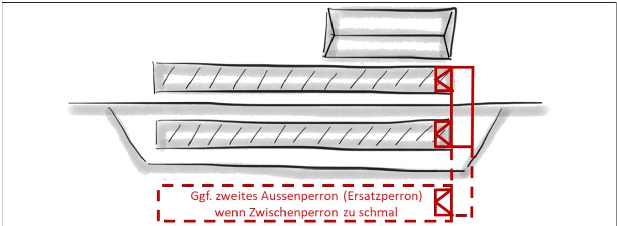
Abbildung 18: Schemaskizze Typ M6 Zugang zum Perron über das Gleis oder Strassenquerung
