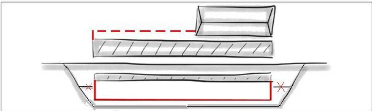
Abbildung 9: Schemaskizze Typ M1a Perronverbreiterung mit Landerwerb oder Aufheben eines Gleises
