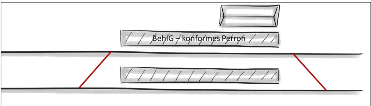
Abbildung 17: Schemaskizze Typ M5 Spurwechsel/Perronwechsel
