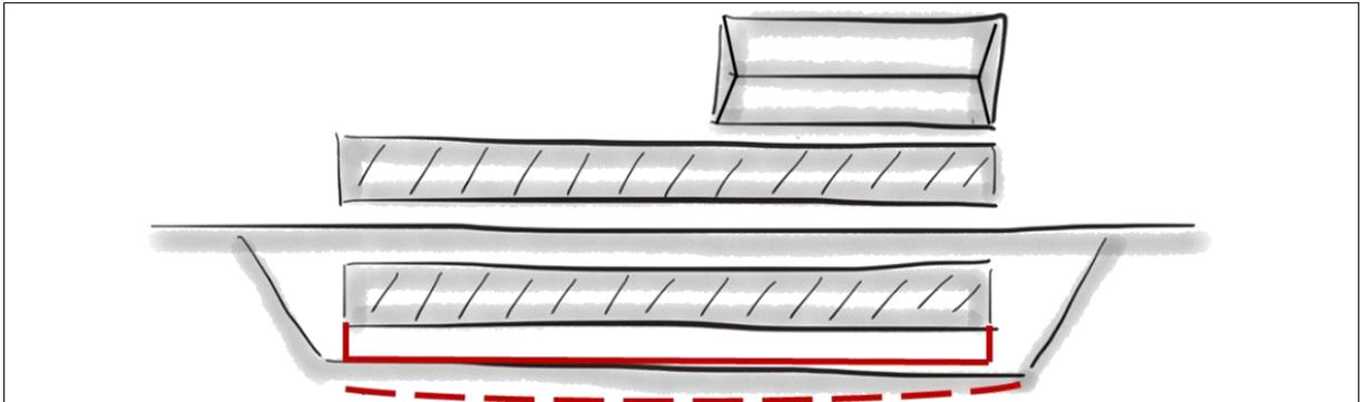
Abbildung 10: Schemaskizze Typ M1b Perronverbreiterung mit Gleisspreizung
