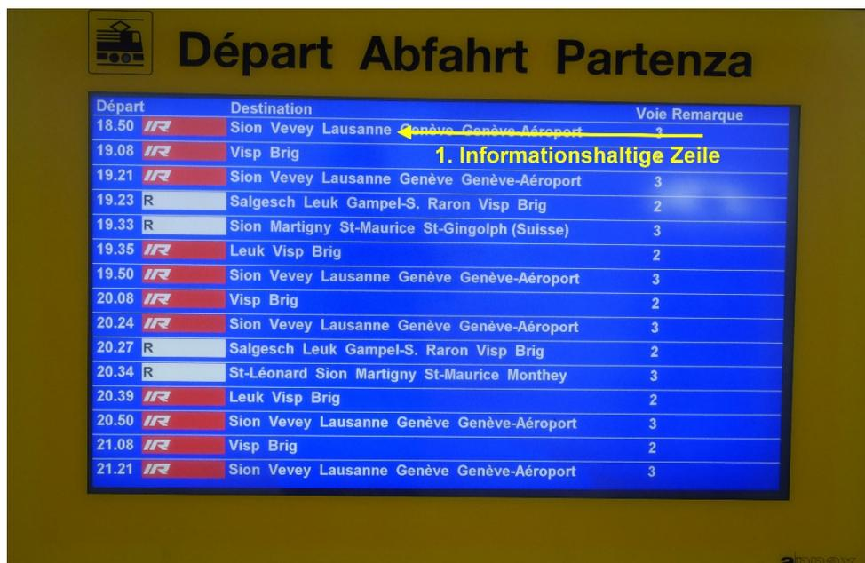
Abbildung 15: Die erste Informationszeile als Bezugspunkt für die Höhenangabe einer Anzeigetafel (gelber Pfeil).
