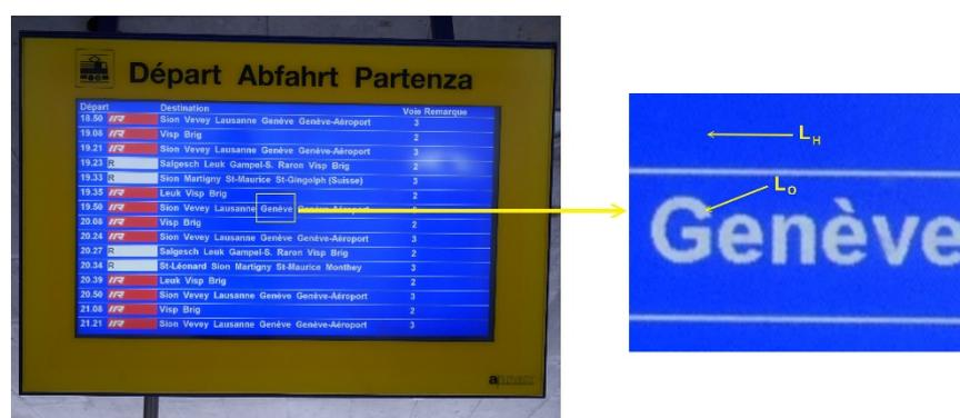
Abbildung 1: Erläuterung der Kontrastformel. In der linken Bildhälfte ist ein Monitor dargestellt, wie er häufig an Bahnhöfen vorzufinden ist. Die Ausschnittvergrößerung in der rechten Bildhälfte zeigt, auf was sich die Leuchtdichten  $L_O$  von Objekt (Schriftzeichen) und  $L_H$  und Hintergrund beziehen. In der dargestellten Situation liegt ein positiver Kontrast nach Michelson vor, da helle Zeichen auf dunklem Hintergrund gegeben sind.
