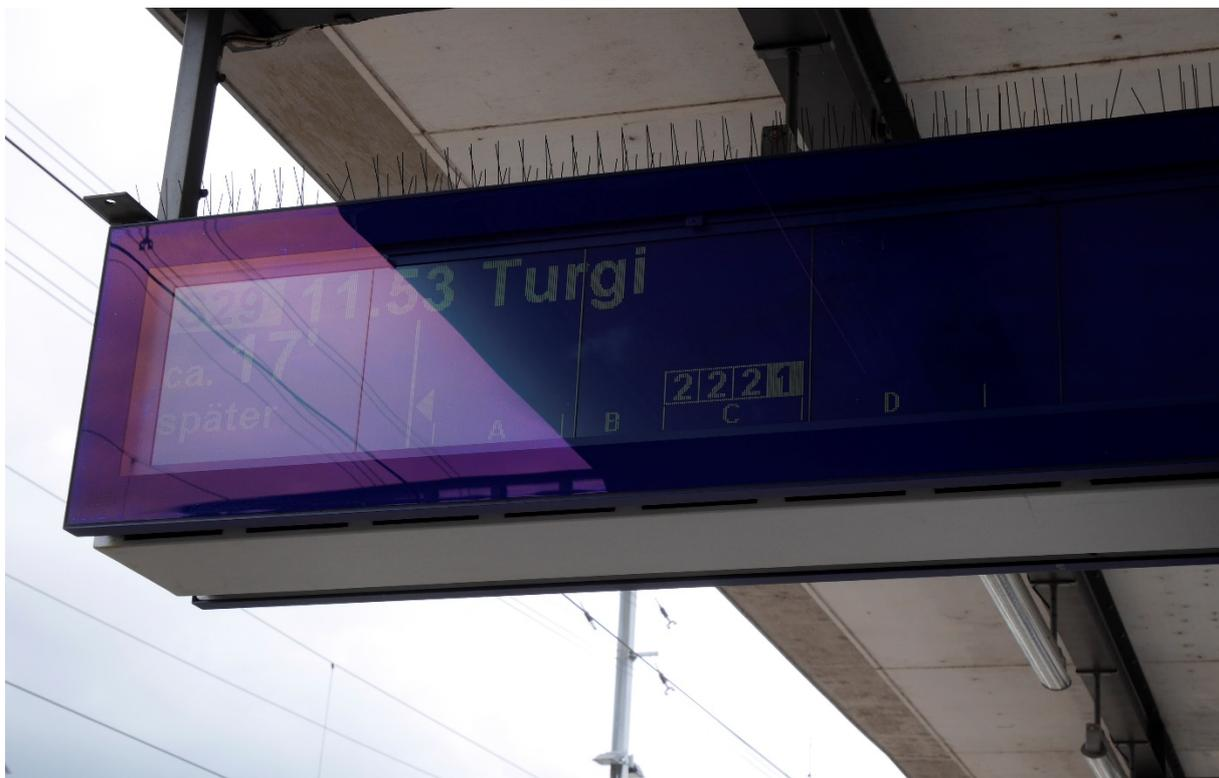
**Abbildung 12: Kontrastvermindernde Reflexionen bei einer Anzeige im Freien. Es wird ersichtlich, dass die Reflexionen die Lesbarkeit praktisch vollständig verunmöglichen können. Ein bewölkter Himmel kann eine höhere Leuchtdichte aufweisen als ein wolkenloser Himmel.**
