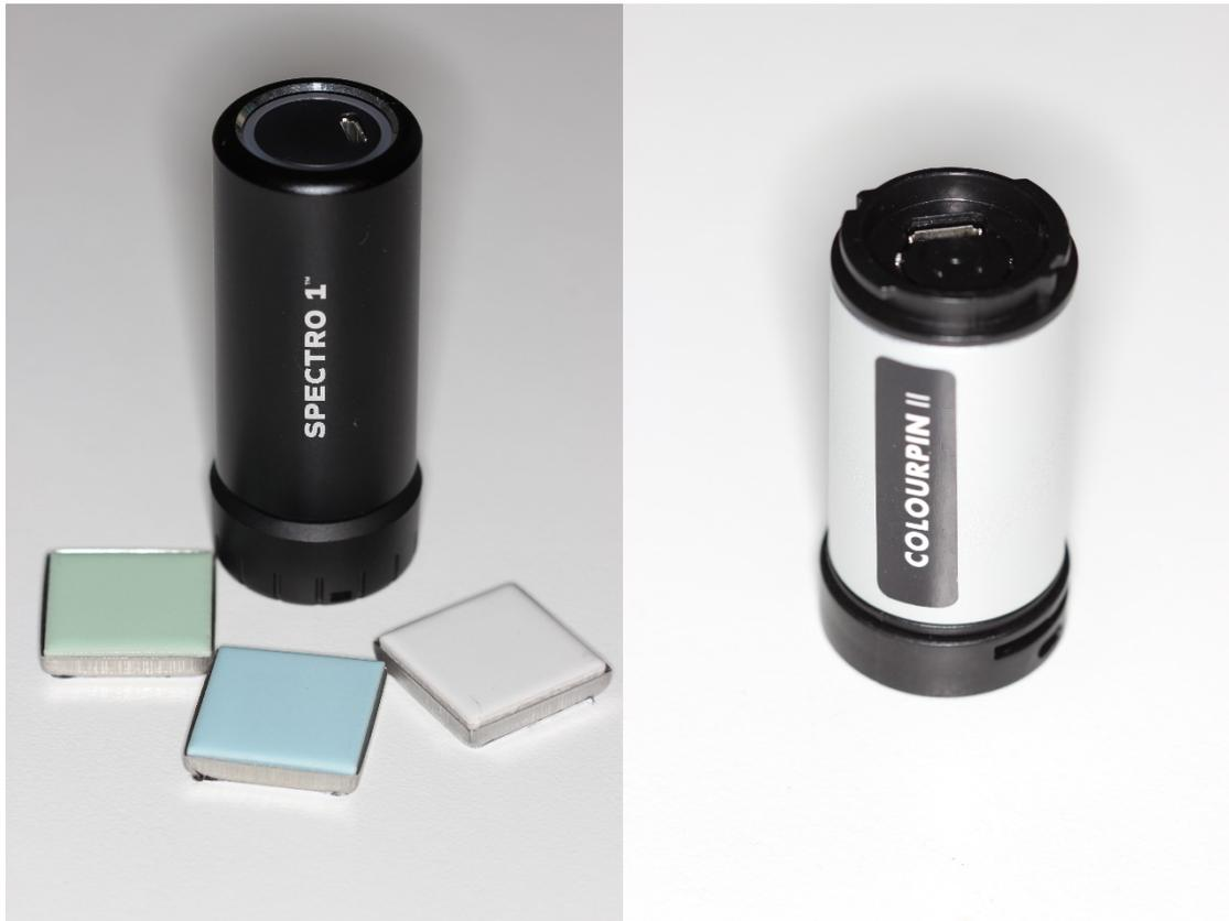
**Abbildung 10: Links: Spectro 1 mit den drei Eichkacheln, rechts: Colourpin II mit aufgesetztem Reflexionsnormal für die Kalibration.**
