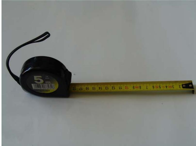
**Abbildung 18:** Laufmeter für Fahrzeugbreite (zusammen mit Winkel)
