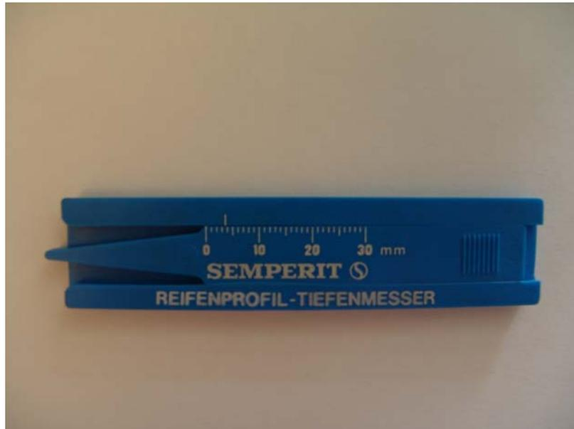
Abbildung 16: Schieblehre für Profiltiefe und Verschleissring-Breite
