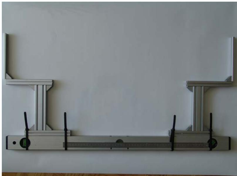
Abbildung 13: Schieblehre für Reifendurchmesser
