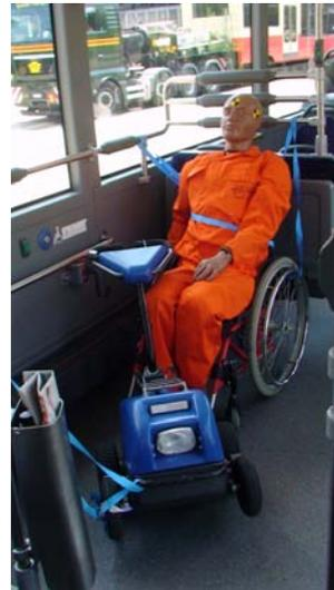
*Bild 15: Insasse mit Handrollstuhl und Zugerät 'Swisstrac' entgegen der Fahrtrichtung, Swisstrac leicht schräg in Richtung mittlerer Tür (Szenario 3, Versuch 1)*
