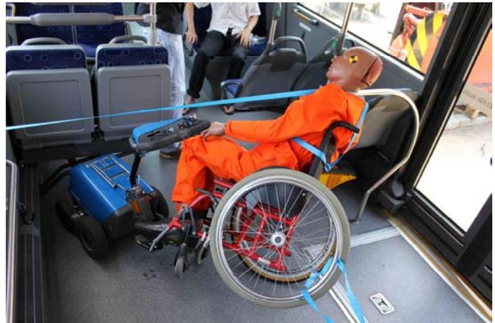
*Bild 23: Insasse mit Handrollstuhl und Zugerät 'Swisstrac' schräg zur Fahrtrichtung (Szenario 4, Versuch 2)*
