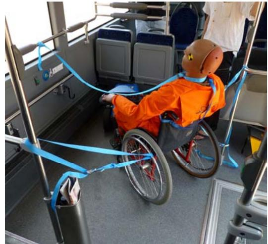
*Bild 21: Insasse mit Handrollstuhl und Zugerät 'Swisstrac' schräg zur Fahrtrichtung (Szenario 4, Versuch 1)*
