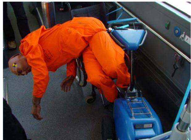
Bild 6: Insasse mit Handrollstuhl und Zugerät 'Swisstrac' in Fahrrichtung (Szenario 1, Versuch 2)
