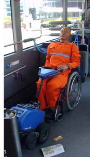
Bild 9: Insasse mit Handrollstuhl und Zugerät 'Swisstrac' entgegen der Fahrtrichtung (Szenario 2, Versuch 1)
