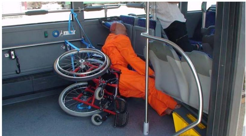
Bild 26: Insasse mit Handrollstuhl quer zur Fahrtrichtung, das Zugerät 'Swisstrac' befindet sich links neben dem Insassen (Szenario 5, Versuch 1)
