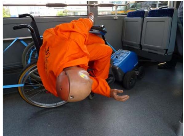
Bild 3: Insasse mit Handrollstuhl und Zugerät 'Swisstrac' in Fahrtrichtung (Szenario 1, Versuch 1)
