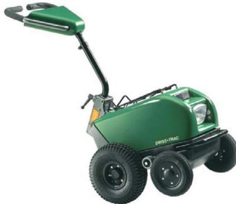
*Bild 2: Zugerät 'Swisstrac' für Handrollstühle (Quelle: [www.swisstrac.ch](http://www.swisstrac.ch))*
