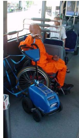
Bild 32: Insasse mit Handrollstuhl quer zur Fahrtrichtung, das Zugerät 'Swisstrac' befindet sich rechts neben dem Insassen (Szenario 6, Versuch 1)
