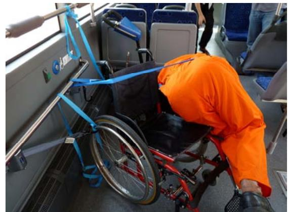
*Bild 29: Insasse mit Handrollstuhl quer zur Fahrtrichtung, das Zugerät 'Swisstrac' befindet sich links neben dem Insassen (Szenario 5, Versuch 1)*
