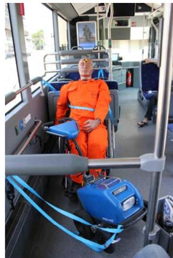
Bild 18: Insasse mit Handrollstuhl und Zugerät 'Swisstrac' entgegen der Fahrtrichtung, Swisstrac leicht schräg in Richtung mittlerer Tür (Szenario 3, Versuch 2)
