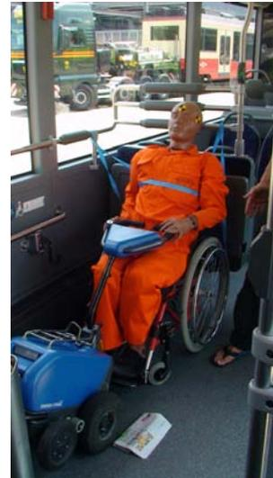
Bild 12: Insasse mit Handrollstuhl und Zugerät 'Swisstrac' in Fahrtrichtung (Szenario 2, Versuch 2)
