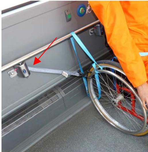
*Bild 1: Sicherheitsvorrichtung in Bussen in Form eines Gurtbandes mit Haken*
