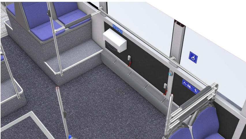
Abbildung 14 : Rollator-Rest / Rollator Sicherungseinheit ohne Rollator
