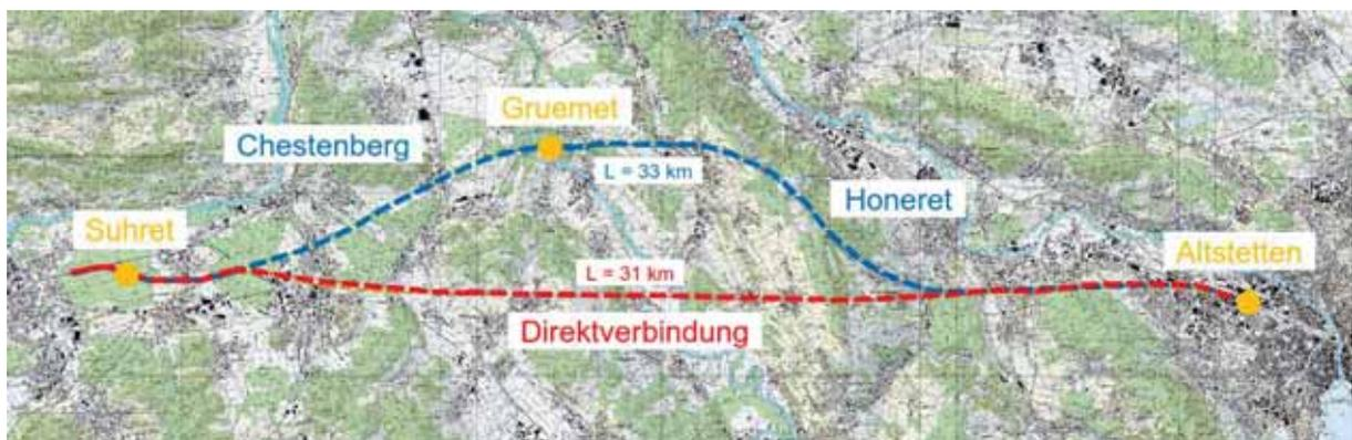
Abbildung 2 Horizontale Linienführung Direktverbindung und Chestenberg / Honeret Einbindung in SBB-Netz:
