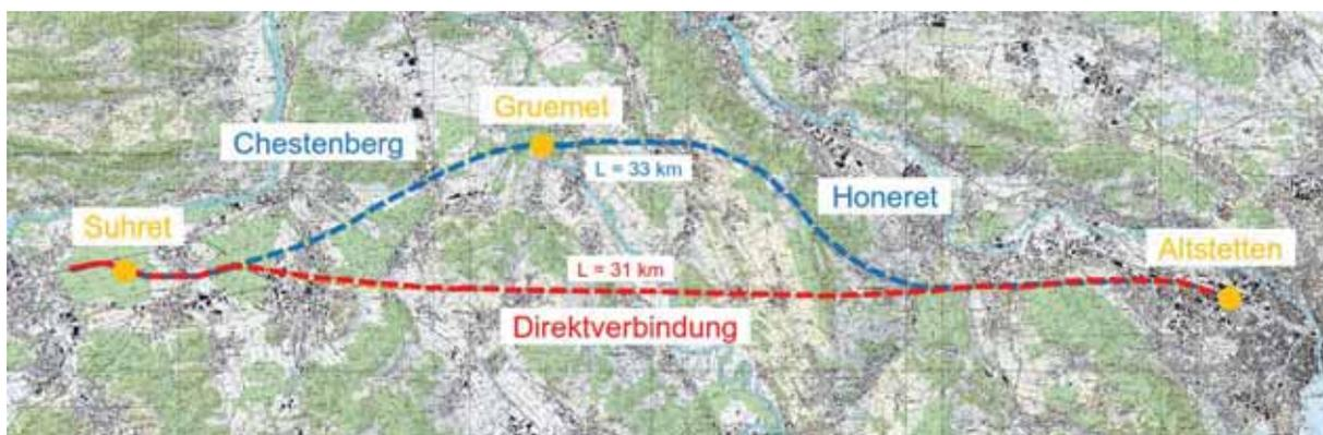
Für die Variante Chestenberg-/Honeret-Tunnel wurde aus Gründen der Genehmigungsfähigkeit letztlich eine Linienführung mit Unterquerung der Reuss im Bereich Gruemet zugrunde gelegt. Die Gesamtkosten für diesen Lösungsansatz betragen 7.2 Mrd. Franken. Bei der Variante Direktverbindung belaufen sich die Gesamtkosten auf 6.1 Mrd. Franken (jeweils Erwartungswert).
