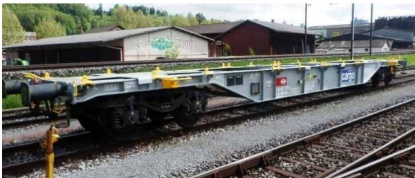
Abbildung 4: Beispielhafter Einheitswagen vom Typ Sgnss
