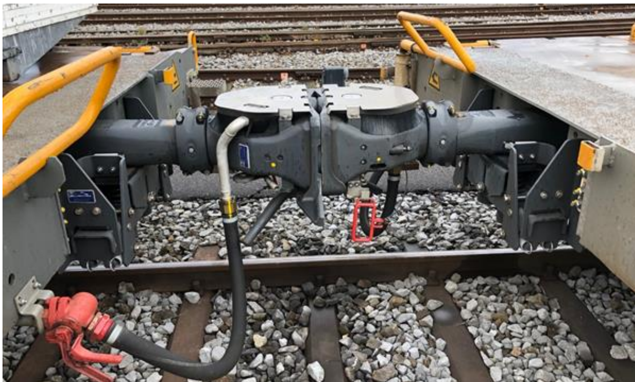
Abbildung 1: Automatische Kupplung vom Typ Scharfenberg der SBB Cargo
