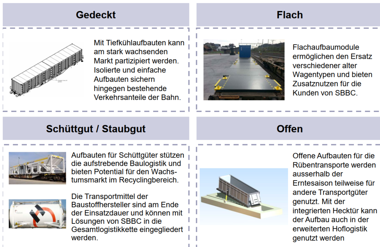
Abbildung 5: Modulares Aufbausystem für den Standard-Unterbau
