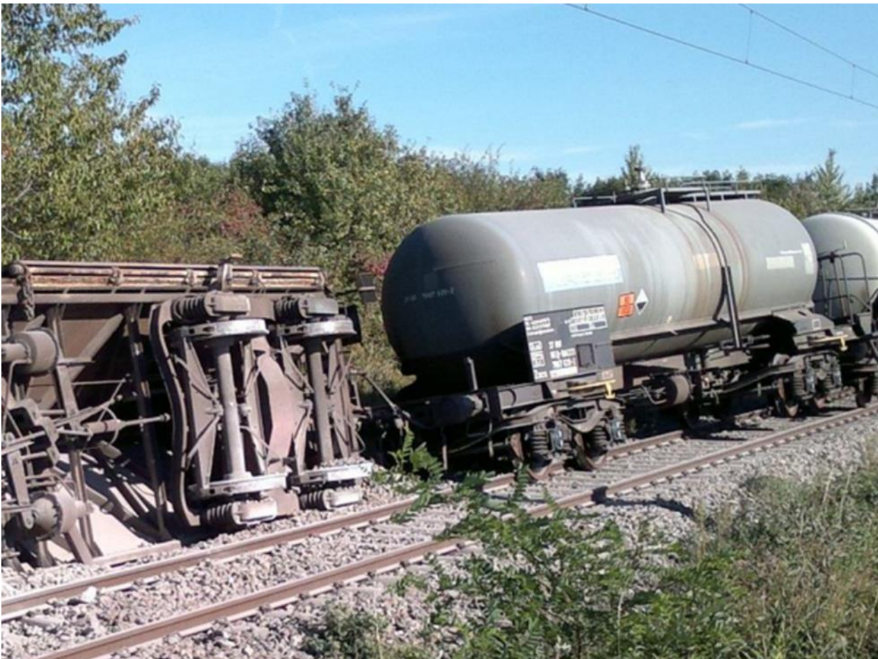
Abbildung 4-1: Beide Wagen sind entgleist, der Wagen rechts ist jedoch nur als „entgleist“ klassifiziert, während der Wagen links zusätzlich noch als Wagen „mit Schaden am Wagenaufbau“ gezählt wird. Umgekippte Wagen wurden auch dann als „mit Schaden am Wagenaufbau“ gezählt, wenn der eigentliche Wagenaufbau auf den Fotos nicht sichtbar war. Beim Wagen rechts darf eine Freisetzung von Gefahrgut als unwahrscheinlich bezeichnet werden, beim Wagen links ist die Wahrscheinlichkeit einer Freisetzung jedoch sicherlich stark erhöht. (Quelle: Verkehrssicherheitsarbeit für Österreich (versa) [7], Unfall A-005)
