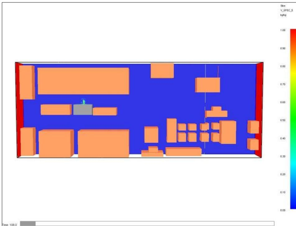
Abbildung 10: Beginn der Freisetzung von Chlor aus dem Gebäude (Türe). Wind: 1 m/s von links (im Modell).
